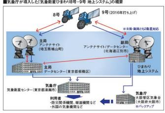
■気象庁が導入した「気象衛星ひまわり8号・9号 地上システム」の概要
